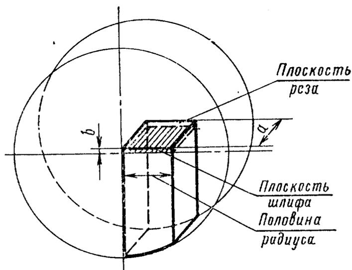
1.4. Длину образца  $a$  в направлении оси прутка устанавливают не менее 10—12 мм. Припуск  $b$  на шлифование должен быть больше или равен 0,5 мм (см. чертеж).
